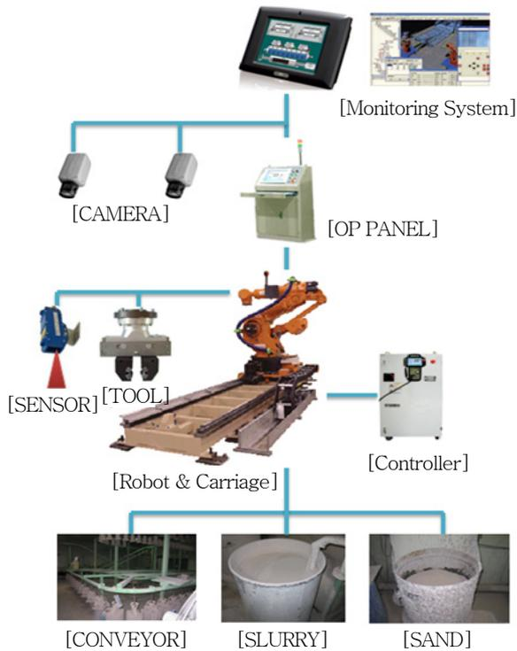
(그림 10) 탈사·사상공정시스템 고도화 구조도
